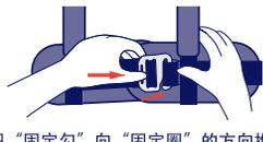
把“固定钩”向“固定圈”的方向推动, 并把“固定钩”微微向上倾斜, 向上拉动使“固定钩”的弯臂勾进入“固定圈”里
